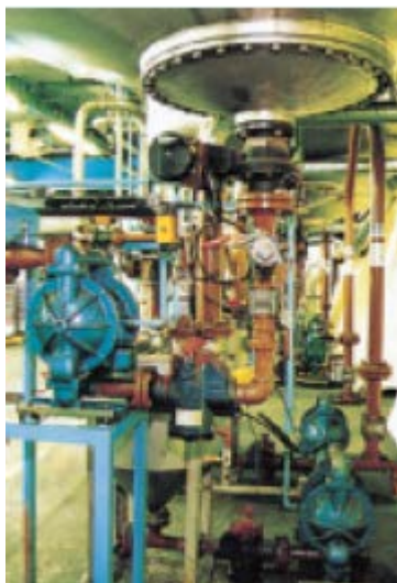
Часть фильтрационного процесса, осуществляемого на предприятии крупной многонациональной корпорации по производству красителей, где насосы Vlagdon 50 используются для питания полностью
